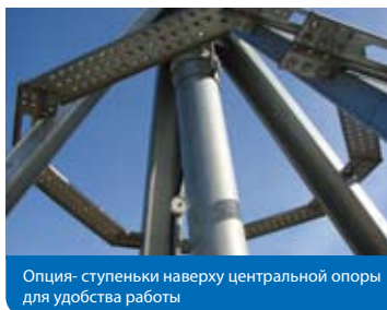
Центральный подшипник усилен и расположен на сходящихся вверх ногах опоры
